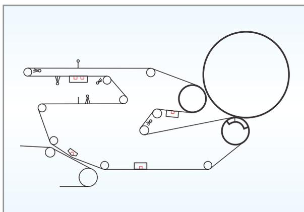
Figura 3: Fourdrinier + rolo prensa com sucção + prensa dry press
