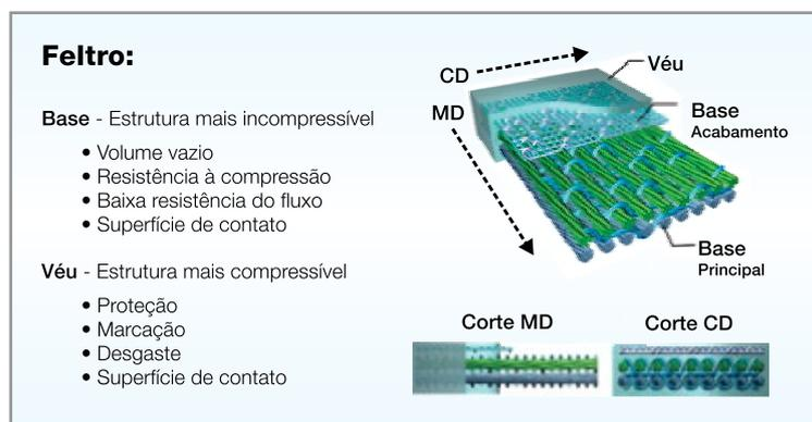
Figura 14: Estrutura do feltro - diagrama
