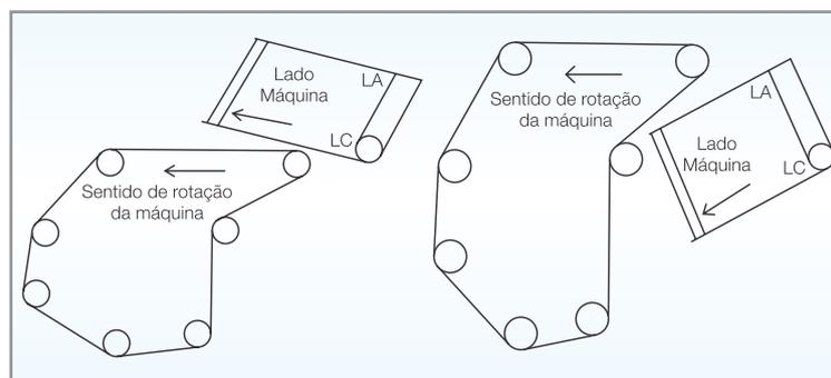
Figura 1: Posicionamento e passamento incorreto do feltro
