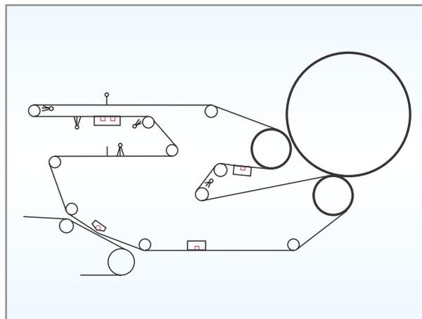
Figura 2: Fourdrinier + prensa dry press + prensa venta nip
