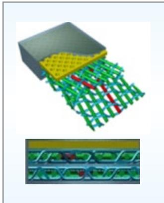
Figura 24: Feltro multiaxial polimérico
