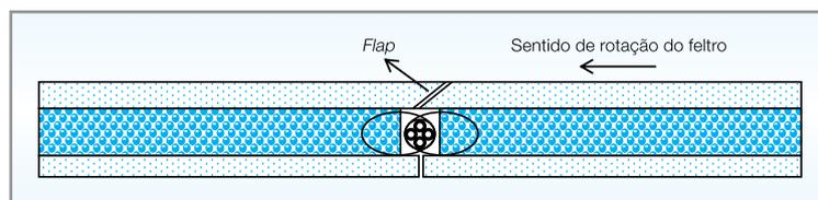
Figura 2: Sentido de rotação de feltro com emenda
