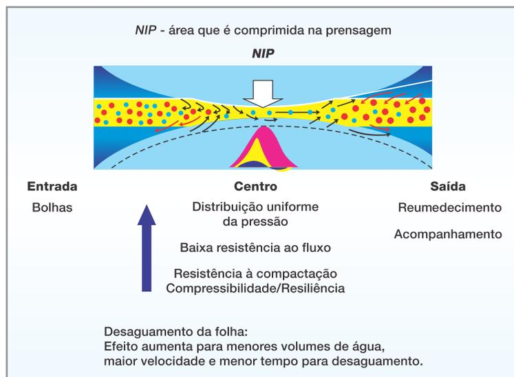
Figura 18: Funções do feltro – desaguamento na prensa
