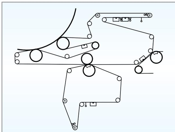
Figura 1: Fourdrinier + duplo feltro + prensa dry press
