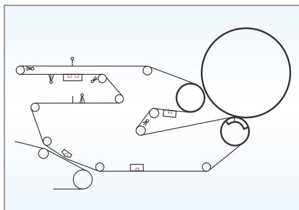
Figura 4: Rolo inclinado com sucção + rolo prensa com sucção + prensa dry press
