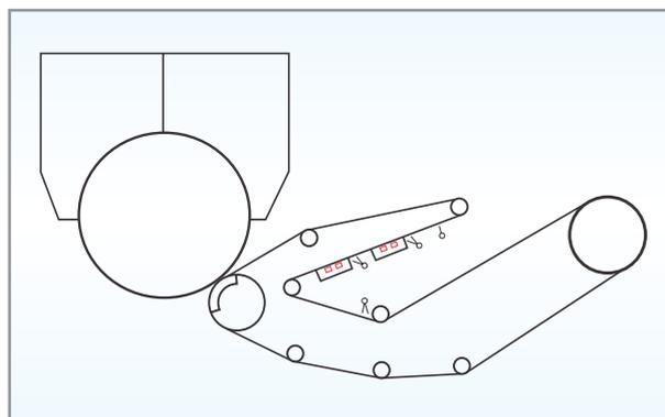
Figura 7: CrescentFormer (CF) + rolo prensa com sucção
