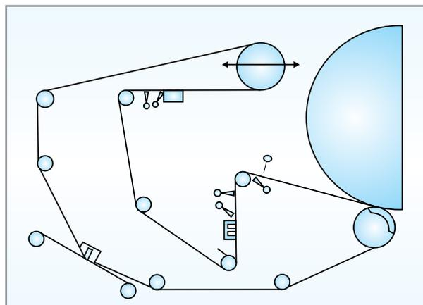
Figura 6: Tela formadora dupla + rolo prensa com sucção
