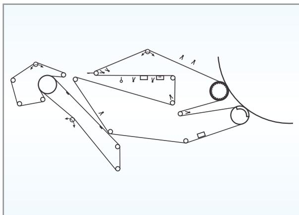
Figura 5: Tela formadora dupla + rolo prensa com sucção + prensa dry press
