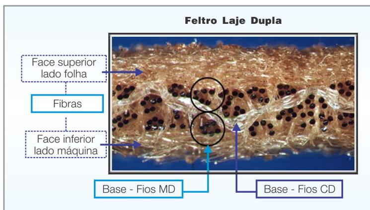
Figura 15: Estrutura do feltro
